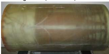
Fig. 5 The PatLoc gradient coil
